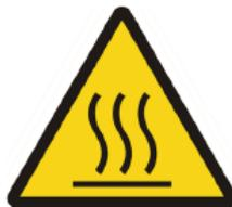
**ОСТОРОЖНО** — лампа: эта табличка может располагаться на панели, закрывающей патрон лампы, для предупреждения пользователя о высокой температуре галогенной лампы.
