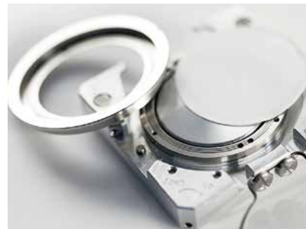
Корреляционный держатель образца для эффективного повторного обнаружения частиц в сканирующем электронном микроскопе
