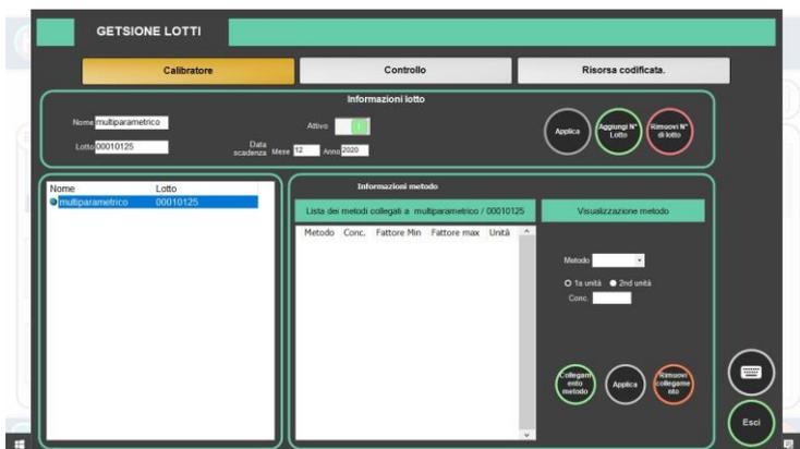
Нажмите кнопку подключения метода и выберите метод, для которого нужно использовать этот стандарт, в нашем случае автоматическое определение яблочной кислоты, также введите концентрацию стандарта, в нашем случае 5 г/л.
