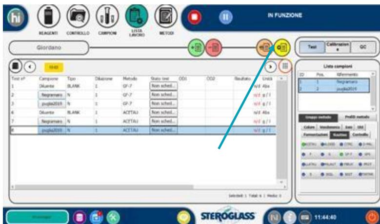
Чтобы запустить анализы, нажмите ЖЕЛТУЮ кнопку, показанную стрелкой. Анализы будут поставлены в график выполнения, и состояние изменится с «Unscheduled» (не запланировано) на «Scheduled» (запланировано). Прибор перейдет в состояние «В ПРОЦЕССЕ ВЫПОЛНЕНИЯ».
