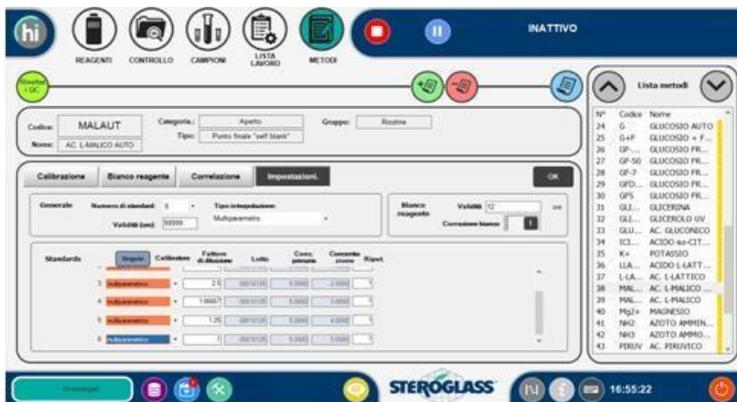
Теперь перейдите в меню образцов и выберите многопараметрический стандарт кнопкой калибратора. Не нужно ничего вводить, при перелистывании выпадающего меню рядом с разделом «Reference» инструмент предлагает ранее активированный многопараметрический стандарт.
